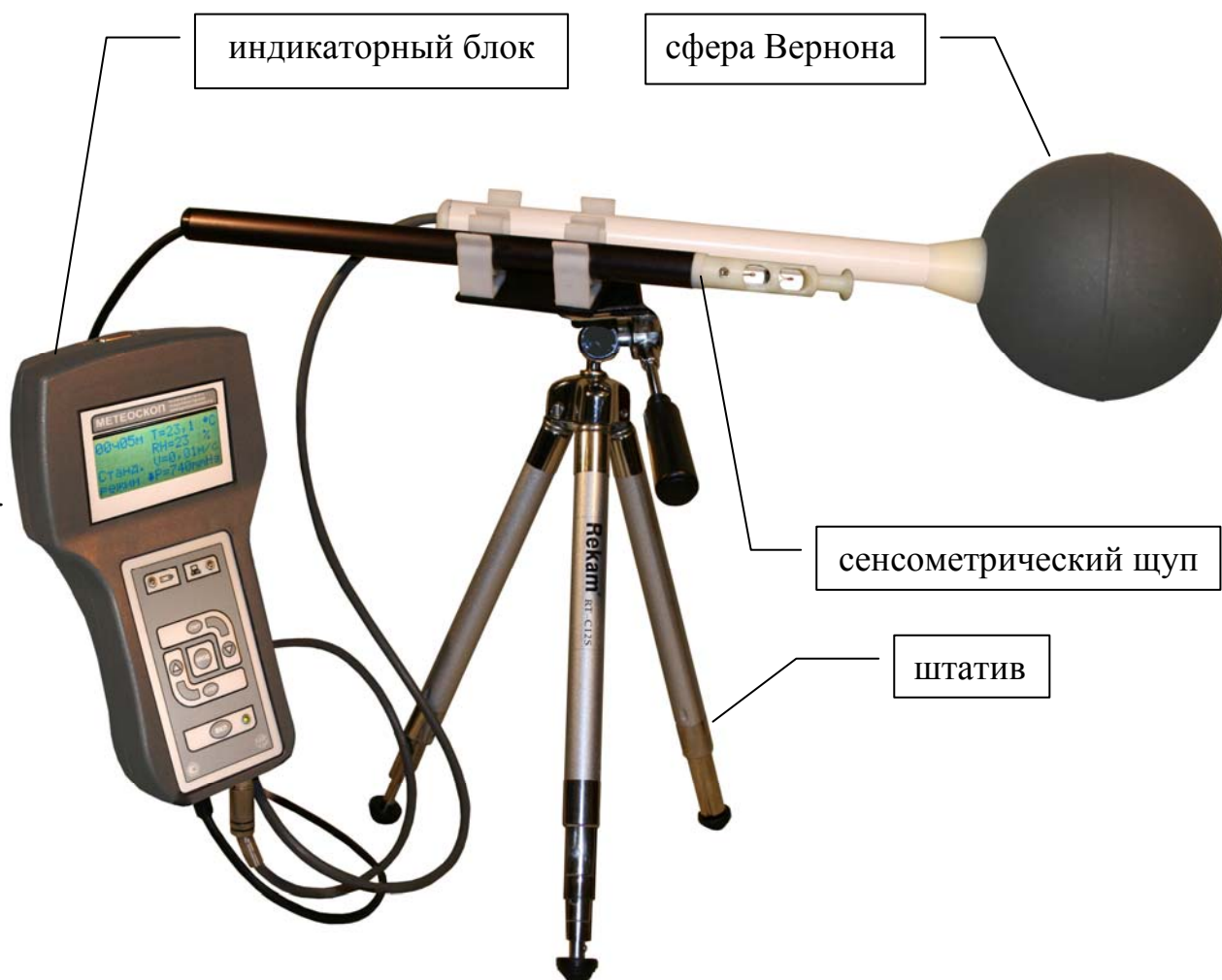
Рис.4. Измеритель параметров микроклимата Метеоскоп в комплекте с шаровым термометром.
